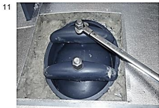
Рисунок 1: Удаление крепления для транспортировки
