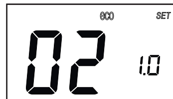
Рис. 12. Настройка отопительной кривой
