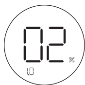
Рис. 32. Настройка отопительной кривой.
